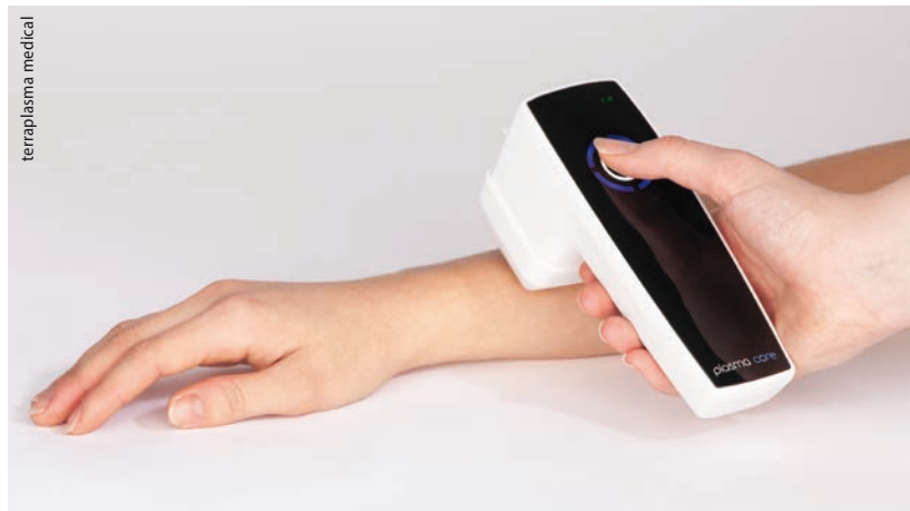
Kaltes Plasma inaktiviert Bakterien, Viren, Pilze sowie Sporen und kann dadurch die Wundheilung fördern, wie dieses mobile Gerät von plasma care®.
