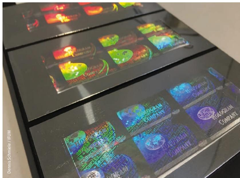
In einen metallischen Werkstoff lassen sich diffraktive Strukturen einprägen.
