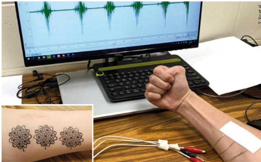
Elektromyographische Sensoren lassen sich mit Papier und Bleistift in erstaunlicher Qualität fertigen. Das Inset zeigt den Sensor ohne Papiersubstrat und Kontaktierung.
