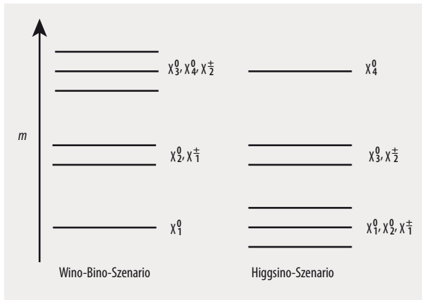
Abb. 5 Bei vorwiegendem Higgsino-Anteil (rechts) bilden das leichteste Chargino und die zwei leichtesten Neutralinos ein Triplet mit nur geringfügiger Massendifferenz. Zerfällen des leichtesten Charginos oder zweitleichtesten Neutralinos ins leichteste Neutralino steht nur wenig Energie zur Verfügung. Bei vorwiegendem Wino-/Bino-Anteil (links) bildet das leichteste Neutralino ein Singulett. Zum leichtesten Chargino und zweitleichtesten Neutralino besteht eine höhere Massendifferenz, sodass Zerfallsprodukte mehr Energie zur Verfügung haben als im Higgsino-Szenario.
