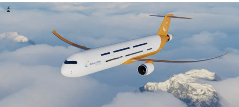
Abb. 5 Bei diesem Konzept eines wasserstoffangetriebenen Langstreckenflugzeugs fällt der große Rumpf auf, in dem sich die Wasserstofftanks befinden, und der Propulsor am Rumpfheck, mit dem der Widerstand der Grenzschicht beeinflusst wird.
