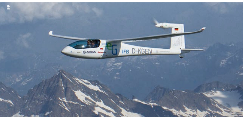
Abb. 1 Der e-Genius – hier bei der Alpenüberquerung – verfügt über einen Elektromotor mit einer Dauerleistung von 40 kW am Leitwerk. In den Batterien sind 90 kWh elektrischer Arbeit gespeichert: Das reicht bei etwa 170 km/h für eine Strecke von über 400 Kilometern.
