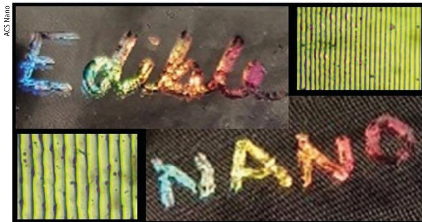
Nanostrukturen (gelbgrüne Bilder) in getrockneten Schichten aus Maissirup erzeugen essbare Hologramme.
