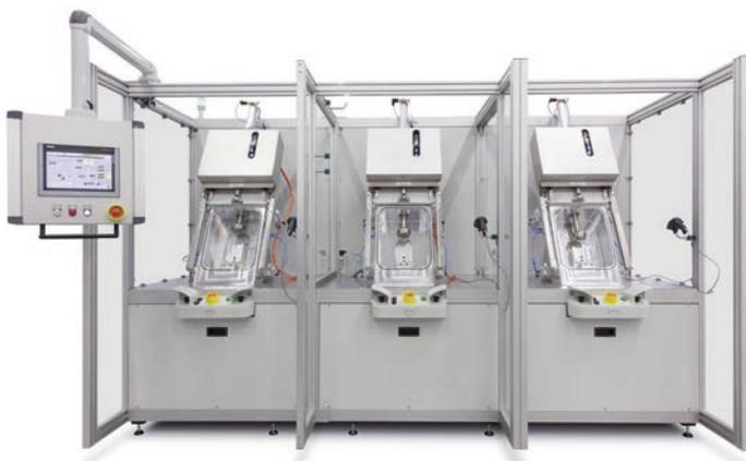
Dichtheitsprüfanlage mit 3 automatisierten Prüfkammern,
