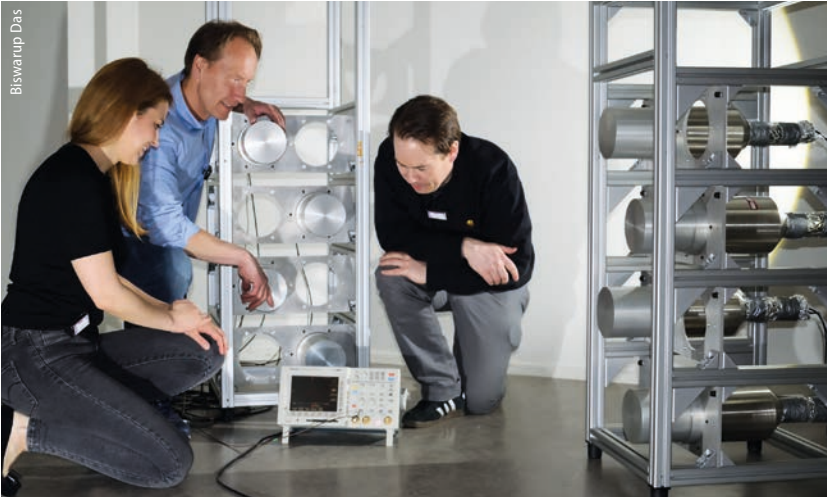
Die Gamma- und Neutronen-Detektoren des schwedischen Demonstrators befinden sich in zwei Gerüsten, die für die Messung einen Meter weit auseinander stehen.
