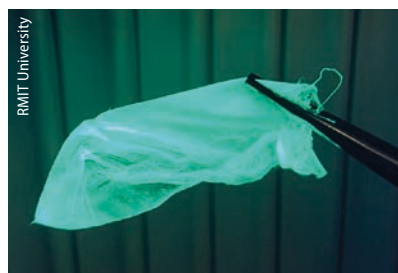
Das elektrogesponnene Vlies aus Polymerfasern und \text{Mg}(\text{OH})_2 -Nanosheets fluoresziert im UV-Licht.
