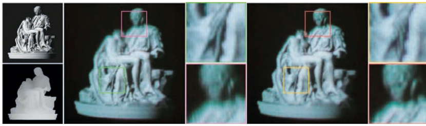
Im Vergleich sind zwei Fokuslagen des mit dem optischen Verfahren vergrößerten 3D-Bilds zu sehen sowie eine Farb- und eine Tiefendarstellung des Objekts (links).
