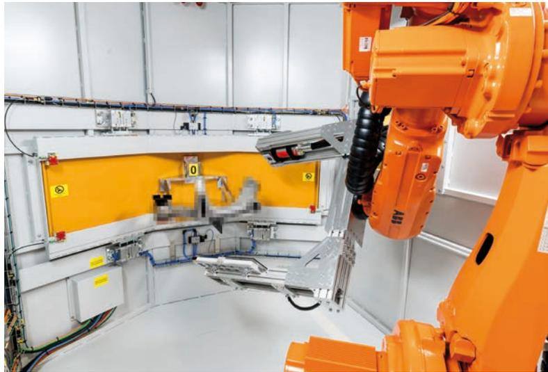
Ein Röntgen-C-Arm fährt ein Bauteil zur Bildaufnahme ab.
