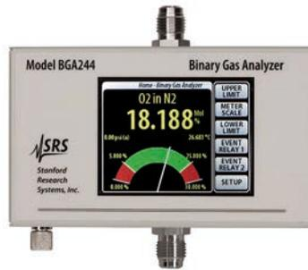
ten zur Molmasse wurden für mehr als 250 Gase und Flüssigkeiten tabellarisch festgehalten, sodass das Gerät zur Messung von zehntausenden Gemischen fähig ist. Weitere Gase können den Datentabellen zugefügt werden.
