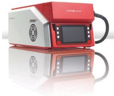
gen wurde der „ThermoStar“ entwickelt. Das Einlasssystem mit Quarzglas- und Platinblende gewährleistet, dass selbst kleinste Konzentrationen analysiert werden können. „OmniStar“ wurde für eine breite Anwendungsvielfalt entwickelt und verwendet eine Edelstahlkapillare. Anders
