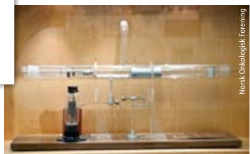
Nachbau des ersten Linearbeschleunigers, den Rolf Wideröe in Aachen entwickelt hat.
