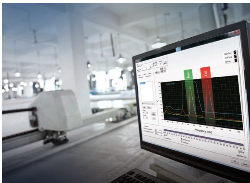
Laservibrometer erlauben zuverlässige OK/nOK-Entscheidungen bei 100 %-Kontrollen in automatisierten Fertigungsverfahren. Im Bild: Die Prüfsoftware QuickCheck stellt Toleranzen als Hüllkurven dar.
