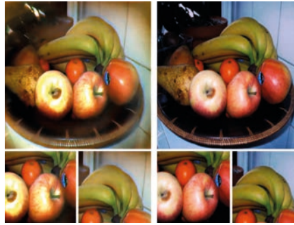
Die Metalinse der Kamera erreicht eine erstaunliche Abbildungsqualität (links) verglichen mit einer konventionellen Optik.
