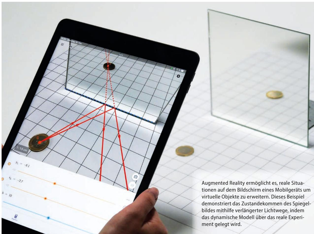
Augmented Reality ermöglicht es, reale Situationen auf dem Bildschirm eines Mobilgeräts um virtuelle Objekte zu erweitern. Dieses Beispiel demonstriert das Zustandekommen des Spiegelbildes mithilfe verlängerter Lichtwege, indem das dynamische Modell über das reale Experiment gelegt wird.
