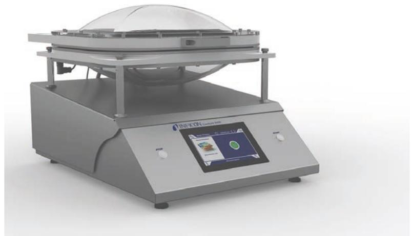
Abb. 1 Verpackungslecksucher Contura S400: Eine Membranpumpe, die Ventilsteuerung, Elektronik und Anzeige sind im Edelstahlgehäuse untergebracht. Die modulare Folienprüfkammer ist auf das Grundgerät aufgesetzt. Sie setzt sich aus zwei symmetrisch aufgebauten Folienkammerringen zusammen. Über die da-
