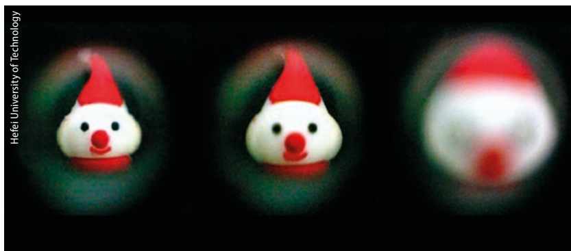
Bei der Aufnahmeserie mit der Flüssiglense war das Motiv für eine Brennweite von 7,5 mm (links) richtig positioniert, für 13 mm (rechts) nicht mehr.
