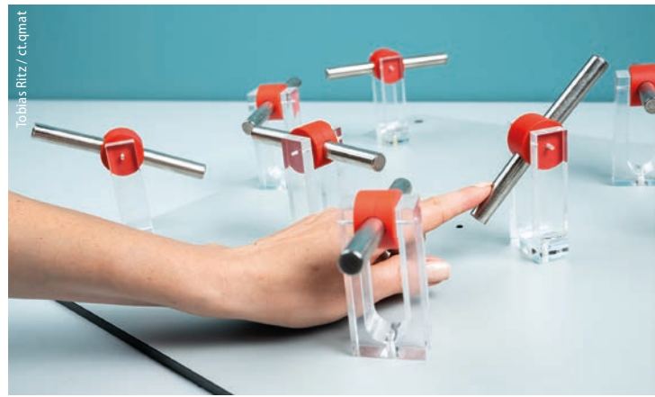
Wenn nicht alle Atomspins in einem Material den niedrigsten Energiezustand einnehmen können, spricht man von Frustration. Die Mitmach-Ausstellung in den Technischen Sammlungen Dresden verdeutlicht das Prinzip mit Permanentmagneten.
