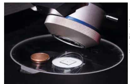
Der dunkle Fleck auf dem Glasträger ist das zweilinsige Mikroobjektiv, das die Stuttgarter Forscher beschichtet haben.
