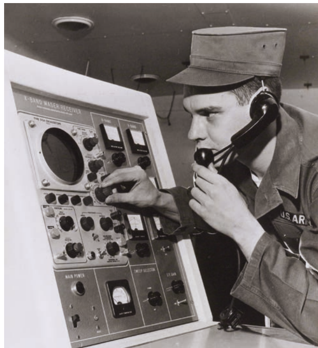
Abb. 4 Der Rubin-Maser fand rasch Verwendung, um die Reichweite wichtiger militärischer Kommunikations- und Radarsysteme zu vergrößern. Getestet wurde dies im U.S. Army Signal Research and Development Laboratory (SRDL) in Fort Monmouth.
