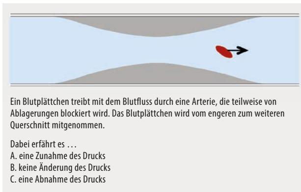
**Abb. 1** Dieses Beispiel für eine Peer-Instruction-Frage behandelt folgendes Schlüsselkonzept: Für inkompressible Flüssigkeiten – ohne Quellen und Senken – hängt der Druck in einer Röhre vom Querschnitt ab.
