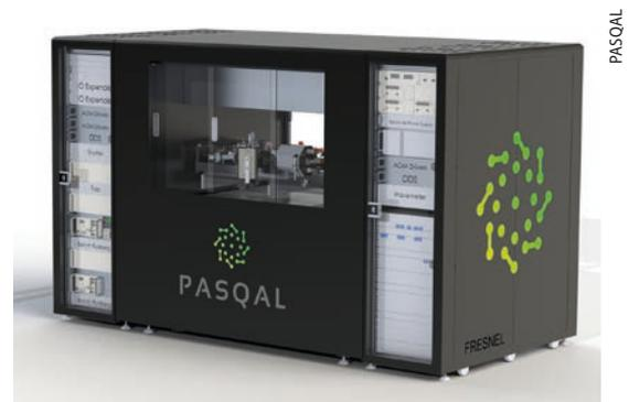
Der analoge Fresnel-Quantensimulator des französischen Unternehmens PASQAL basiert auf neutralen Atomen, die in 2D/3D-Arrays durch optische Pinzetten angeordnet sind und in ihren Rydberg-Zuständen wechselwirken.
