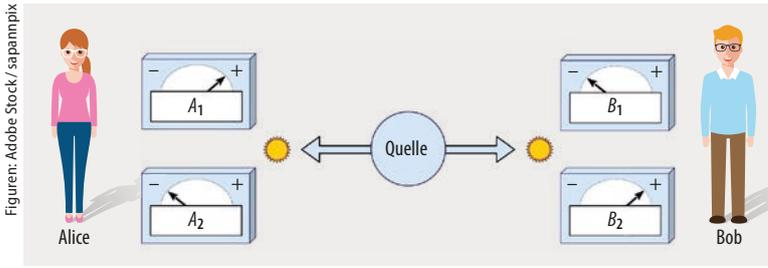
**Abb. 1** Um in einem Experiment Korrelationen zu erzeugen, sendet eine Quelle jeweils ein Teilchen an Alice und Bob. Die beiden können jeweils verschiedene Messungen  $A_i$  oder  $B_i$  durchführen und erhalten unterschiedliche Messergebnisse. Im dargestellten einfachsten Fall sind es zwei mögliche Messungen mit je zwei möglichen Resultaten.
