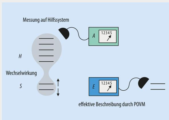
**Abb. i** Eine allgemeinere Messung an einem System  $S$  besteht darin, dass das System mit einem Hilfssystem  $H$  wechselwirkt und dann auf  $H$  eine Observable gemessen wird. In der Tat lässt sich jedes POVM so auffassen.
