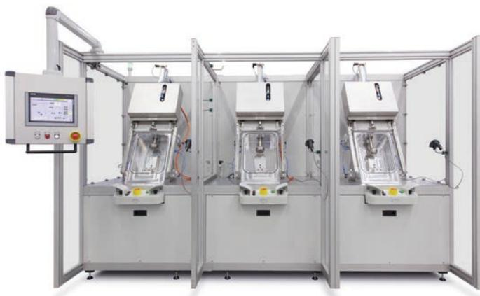
Dichtheitsprüfanlage mit 3 automatisierten Prüfkammern,
