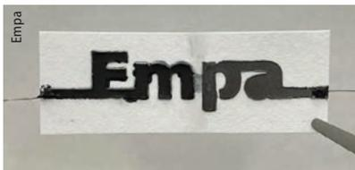
Die Metall-Luft-Batterie ist bioabbaubar und liefert eine Spannung von 1,2 V.
