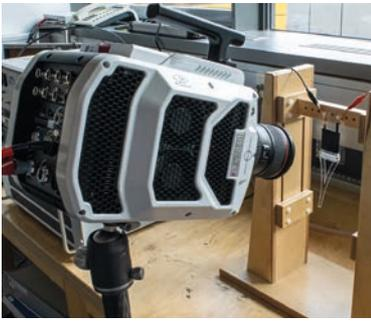
Mit diesen elektrohydraulischen Aktuatoren erfolgt die Nachahmung der Bewegungen, etwa von Insektenbeinen.
