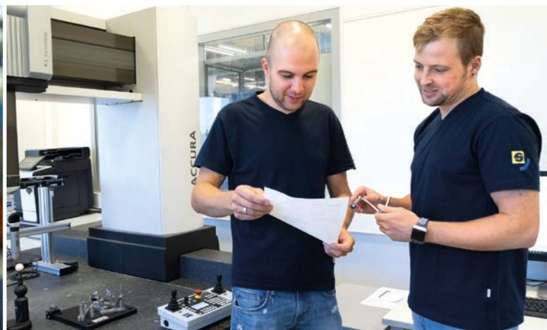
Mit dem Koordinatenmessgerät Zeiss Accura lassen sich im Qualitätsmanagement alle Fertigungsschritte überwachen.
