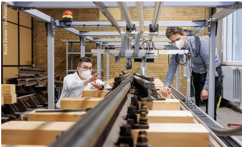
Testmessungen mit dem Sensor auf dem Prüfstand
