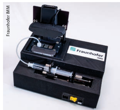
Das neu entwickelte PCR-Schnelltestsystem arbeitet mit einem mikrofluidischen Kanal zum raschen Temperatuausgleich.
