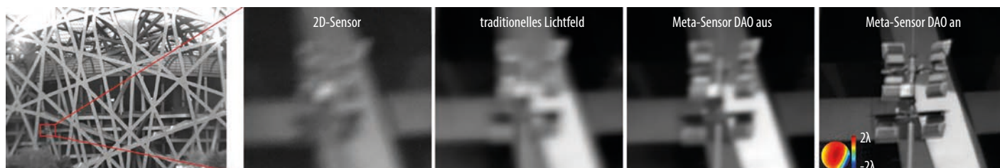
Vergleich der Bilder des neu entwickelten optischen Systems (rechts – ohne und mit Aberrationskorrektur) mit Bildern etablierter Technologien.
