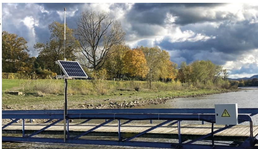
Der Wasserstands-Sensor wurde am Niederrhein bei Wesel getestet.
