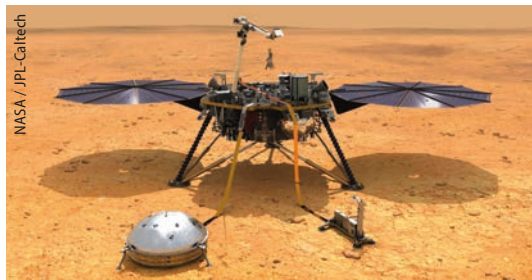
Der Lander nutzt Solarpaneele für die Energieversorgung. Im Vordergrund sind das Instrument für seismische Messungen (links) und der „Mars-Maulwurf“ (rechts) zu sehen.
