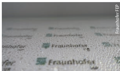
Eine hydrophobe TiO 2 -Beschichtung (oben) wird unter UV-Licht superhydrophil.
