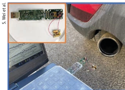
Der Sensor wurde für die Messung am Auspuffrohr in eine Mikrocontrollerplatine integriert, die ein USB-Interface hat.
