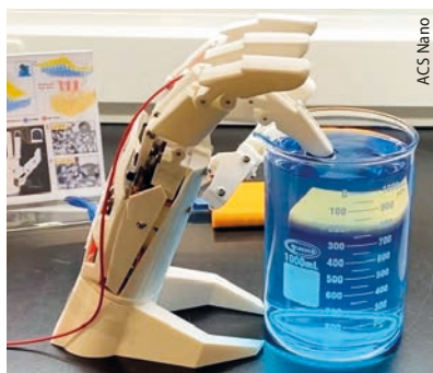
Der triboelektrische Nanosensor befindet sich an der Fingerspitze der Roboterhand.
