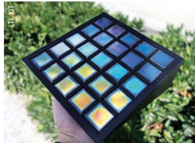
Beim Tintenstrahlgedruckte sind die Eigenschaften optischer Filter gezielt einstellbar.
