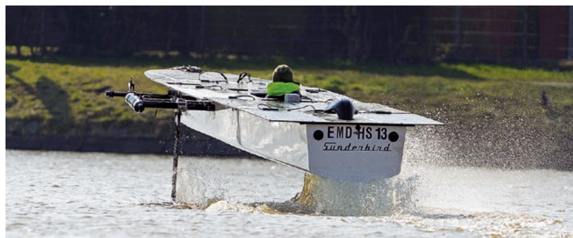
Die Tragflügel heben den Rumpf aus dem Wasser und halbieren so den Wasserwiderstand.
