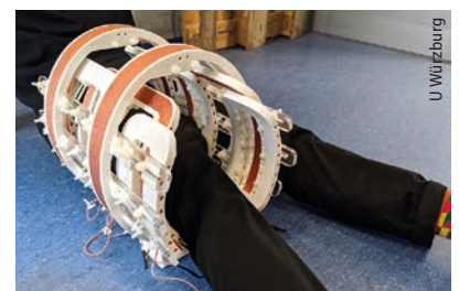
Der MPI-Scanner ist relativ leicht und lässt sich am Oberschenkel anbringen.
