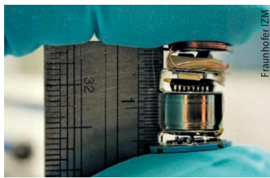
Der Pillen-Sensor misst Impedanzen in schwer zugänglichen Hohlräumen.
