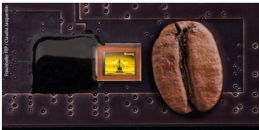
Die Subpixel des Dresdner OLED-Mikrodisplay-Demonstrators sind 2,5 \times 2,5 \mu\text{m}^2 klein.
