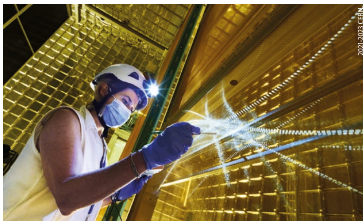
Abb. 2 Anodendrähte im Inneren eines ProtoDUNE-Kryostaten. Das gelbe Licht dient zum Schutz der Lichtdetektoren. Die Faltung der Stahlwände absorbiert die mechanischen Kräfte bei der Befüllung mit flüssigem Argon.
