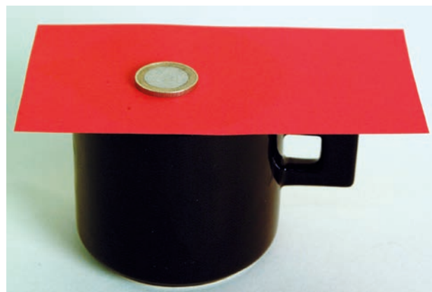
Abb. 2 Ob die Münze beim Ziehen in die Tasse fällt, hängt davon ab, ob auf sie eine Haftkraft oder Gleitreibungskraft wirkt.
