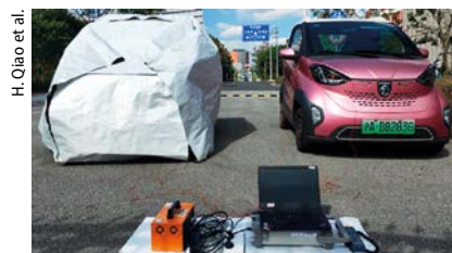
Temperaturmessung am verhüllten Fahrzeug und am Kontrollfahrzeug
