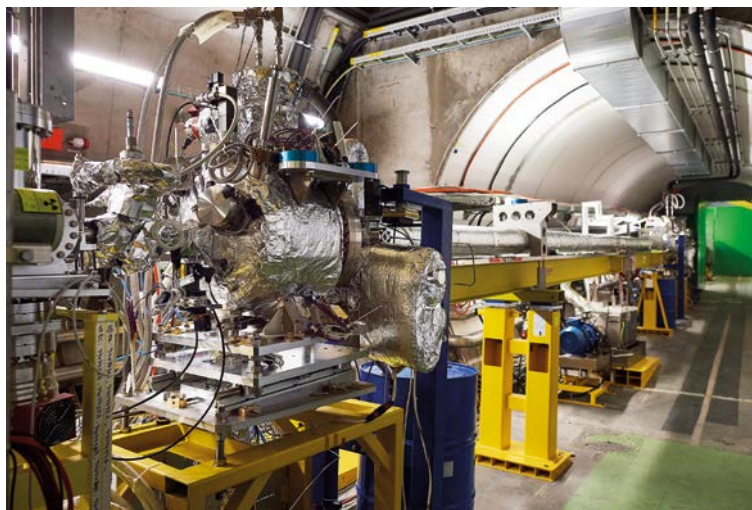
Abb. 5 Eine neuartige Plasmazellentechnologie auf Basis von Rubidiumdampf – hier die Rb-Dampfquelle im Tunnel – bildet das Kernstück des AWAKE-Experiments.
