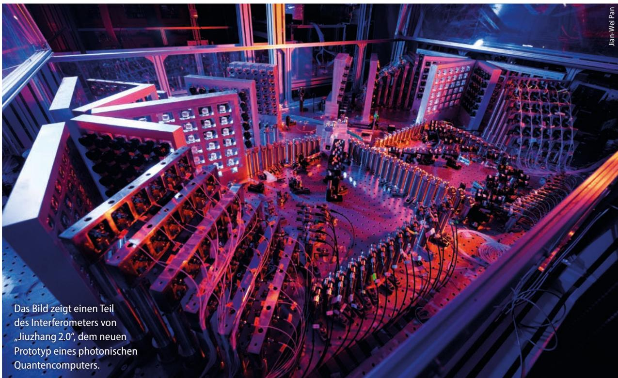
Das Bild zeigt einen Teil des Interferometers von „Jiuzhang 2.0“, dem neuen Prototyp eines photonischen Quantencomputers.
