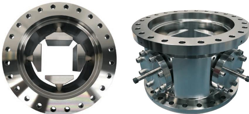
**Abb. 2** Die Detailansicht eines elektrostatischen Steuerers zeigt die vier Ablenklplatten. Die angeschlossene Steuerelektronik erzeugt ein elektromagnetisches Feld, das den Strahl elektrisch geladener Partikel in die gewünschte Richtung ablenkt.
