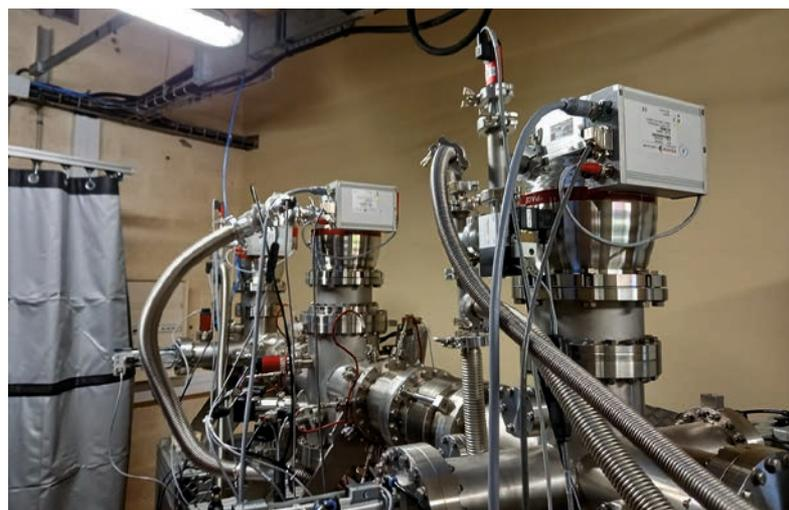
Abb. 6 Montierte Turbopumpen an dem Teststand bei DESIR
