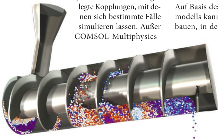
Simulation des Getreidetransports in einem Schneckenförderer
